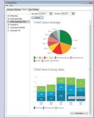
Software encargado de monitorear el estado de la máquina de medición por coordenadas en tiempo real ya distancia.
