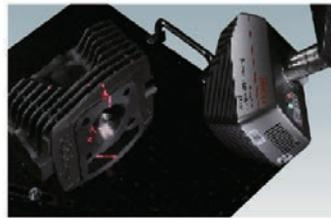
Sensor a Laser para medição sem contato
